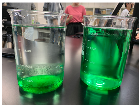
図3、対流によっておこる温度の逆転現象を可視化する実験 サーモグラフィカメラを導入する前は水を着色して再現
